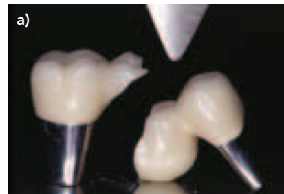
Abb. 11 Brücke der Testreihe B nach erfolgter Bruchlastprüfung (a) und Bruchfläche (b)
